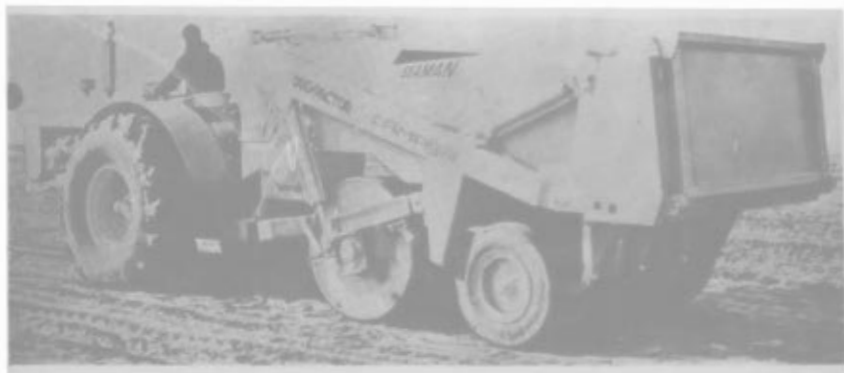
Fig. 10.23.- Equipo compactador combinado, llamado "Duo-Pactor", que consiste en un cajón lastrado sostenido por un rodillo -- largo y liso de hierro que se puede lastrar con agua, y -- una serie de neumáticos, jalados por un tractor agrícola.
