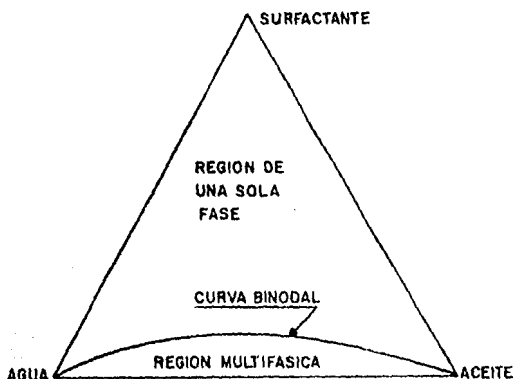
FIG. IX-5 DIAGRAMA TERNARIO DE UN SISTEMA CON MICROEMULSION
