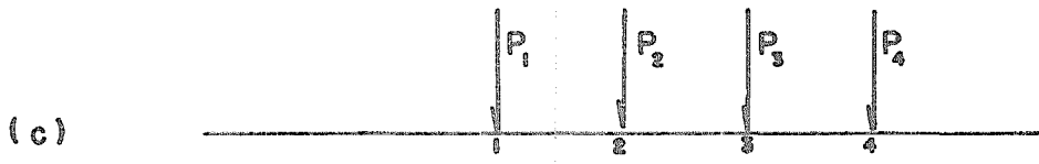
SISTEMA DE CARGAS CONCENTRADAS
