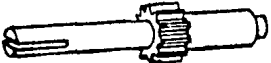
FUNDICION A PRESION EN MOLDE AUTOMATICO DE UNA CAVIDAD (ALEACION DE ZINC)
