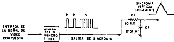
FIGURA 23 CIRCUITO PARA OBTENER LA SINCRONIA VERTICAL
