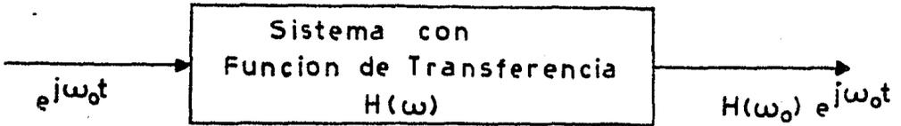
De aquí se concluye que conociendo la función de transferencia  $H(\omega)$  de un sistema lineal e invariante es posible determinar el efecto que tendrá el sistema sobre cada una de las componentes en frecuencia de la señal de entrada.
