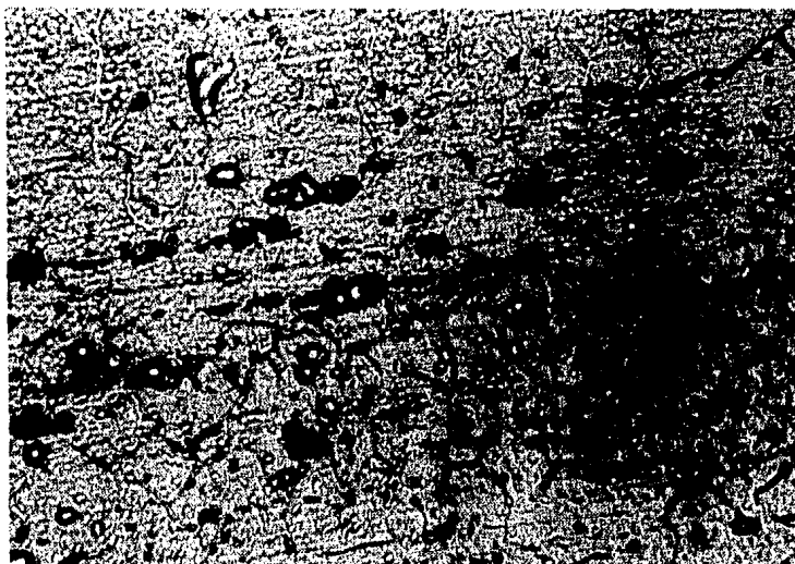
Fotografía no. 1. Estructura de la Aleación 6261-T6 previa a la experimentación. 800 aumentos.
