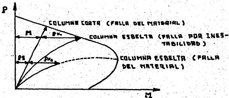
Fig.2. Diagrama de interacción para una sección de columna de concreto reforzado que ilustra el comportamiento P-M de columnas cortas y largas hasta la falla.
