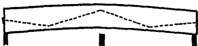
b.- FLEXION DE LA VIGA JAJO EL PREESFUERZO SI NO ESTA SOSTENIDA POR EL APOYO.
