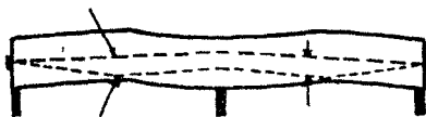
e.- DESVIACION DE LA LINEA E CON RESPECTO A LA LINEA T, DEBIDA AL MOMENTO EN (d).
