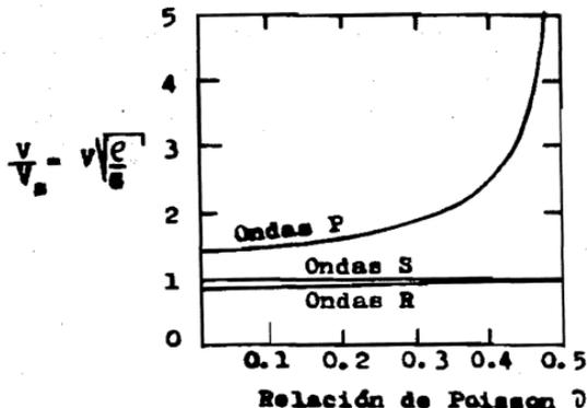
Fig. 3.3 Relación entre  $\nu$  y las velocidades de propagación de ondas P, S y R.
