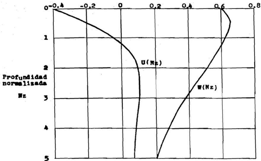
Fig. 3.4a Las funciones  $U(Nz)$  y  $W(Nz)$  para relación de Poisson igual a 0.25
