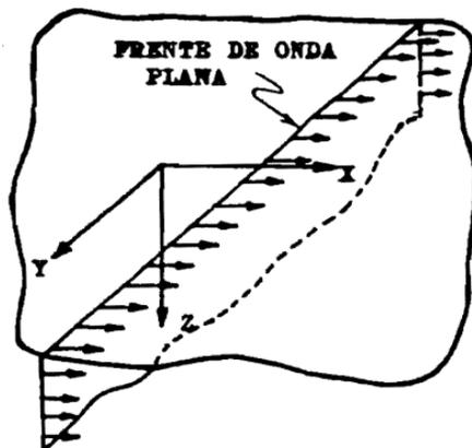
Fig 3.2 . Convención de coordenadas para el semiespacio elástico.
