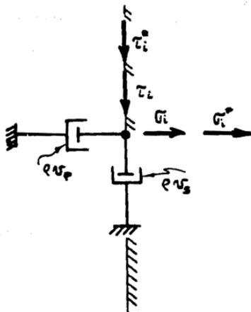
Fig. 3.8 Condiciones de frontera
