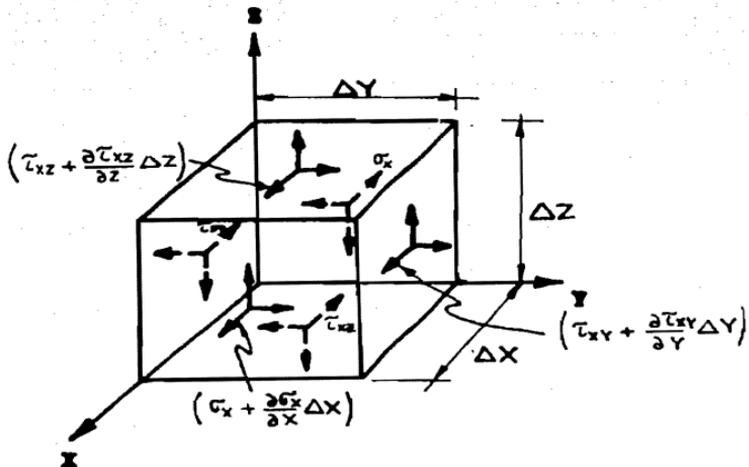
Fig. 3.1. Esfuerzos en un elemento diferencial de un medio elástico infinito.
