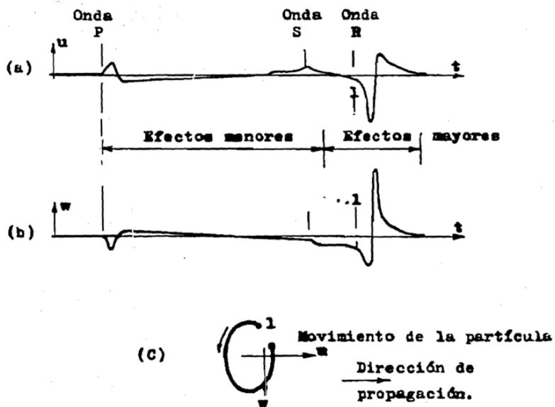
Fig. 3.5 Sistema de ondas en la superficie de un medio ideal, debido a una perturbación.
