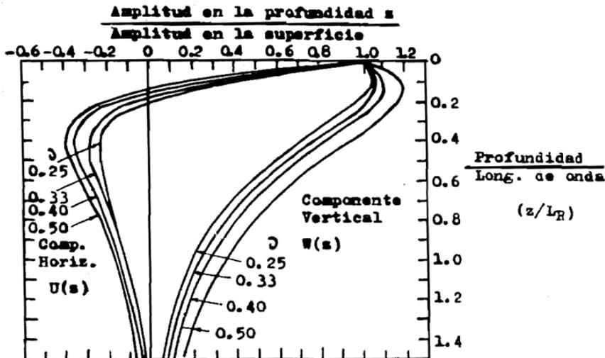
Fig. 3.4 Relación de amplitud contra profundidad adimensional para onda Rayleigh.
