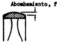
Figura 5.8 Sección de una polea abombada.
