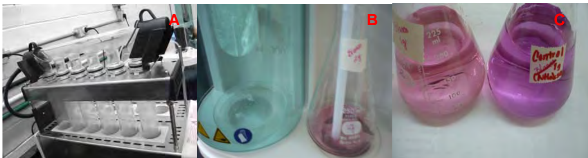
Figura 4.2. Cuantificación de nitrógeno. A) Digestión de la muestra, B) Destilación, C) Muestras valoradas.
