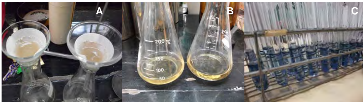
Figura 4.1. Determinación de fósforo en el suelo experimental. A) Filtración de suelo, B) Obtención del filtrado, C) Formación del complejo coloreado.
