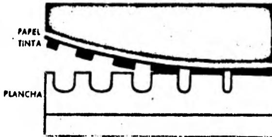
**En el molde o plancha metálica los elementos de impresión aparecen en relieve.**
