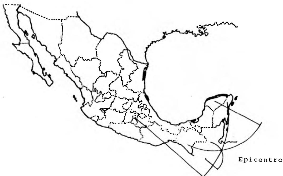
Empleamos las distancias calculadas como los radios de -- los círculos dibujados, con centro en las estaciones; con los primeros dos círculos determinamos dos puntos, y con el ter-- cero precisamos finalmente el sitio del epicentro. Es cierto, que este problema se resolvería con mayor propiedad en la --- geometría reimanniana, pero no se ha llegado a tanto adelan -- to en la sismología.
