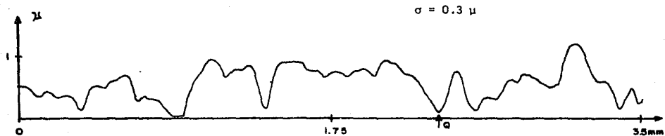
GRAFICA III.3.4.- PERFIL DE LA MUESTRA RUGOSA DE AT R 6 OBTENIDA CON EL PERFILOMETRO.
