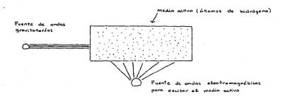
Empezaremos analizando lo que le sucede a la radiación gravitatoria al atravesar una placa de medio activo de espesor x. Si la radiación tiene una intensidad inicial  $\mathbf{I}_{0_G}$ , supondremos que el decaimiento de esta intensidad por absorción del medio es proporcional a  $\mathbf{I}_{0_G}$ dx, por lo que podemos escribir
