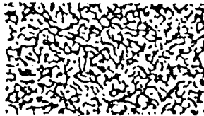
Fig. 1. P.M.O. en un objeto dispersor iluminado con luz de laser.
