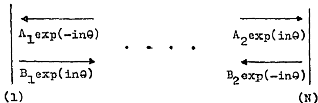
Figura III-2. Ondas entrantes y salientes a los centros dispersores en 1 y N.
