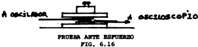
Durante todas las pruebas de respuesta a frecuencia la amplitud pico a pico de la señal. se mantuvo en :  $V_i = 0.2 \pm 0.006$  V.
