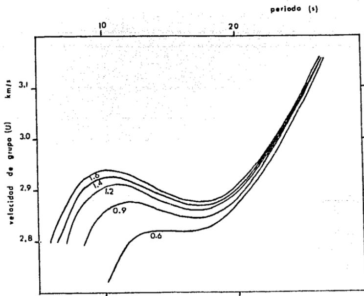
FIGURA A.1 Efectos de la variación de la velocidad S en la capa 1, desde 0.6 km/s hasta 1.6 km/s.
