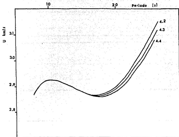
FIGURA A.10 Efectos de la variación de la velocidad  $S$  en la capa 6, desde 4.2 km/s hasta 4.4 km/s.
