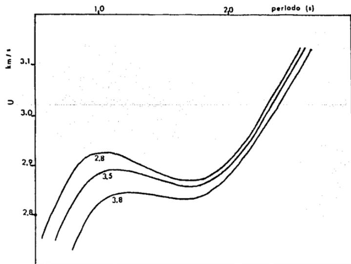
FIGURA A.3 Efectos de la variación de la velocidad  $S$  en la capa 2, desde 2.8 km/s hasta 3.8 km/s.
