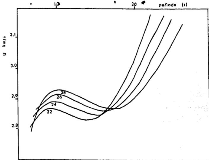
FIGURA A.6 Efectos de la variación del espesor de la capa 3, desde 22 km hasta 28 km.
