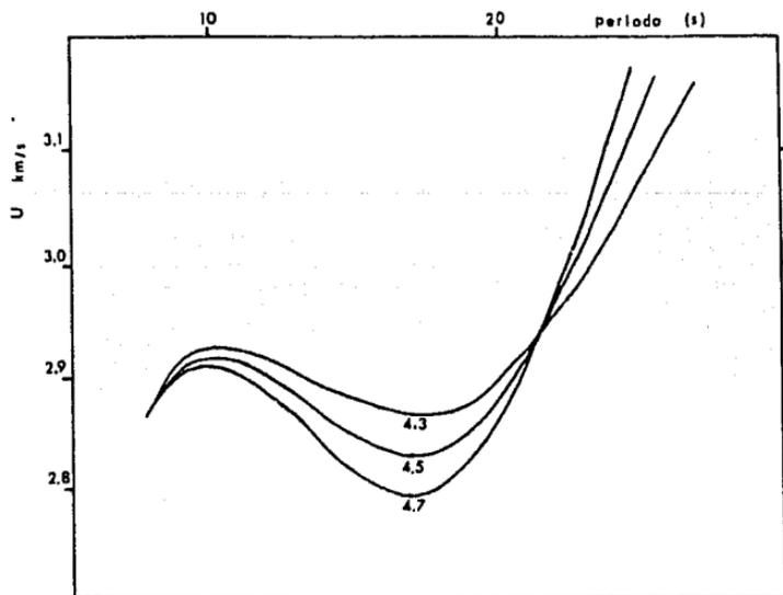
FIGURA A.7 Efectos de la variación de la velocidad  $S$  en la capa 4, desde 4.3  $\text{km/s}$  hasta 4.7  $\text{km/s}$ .
