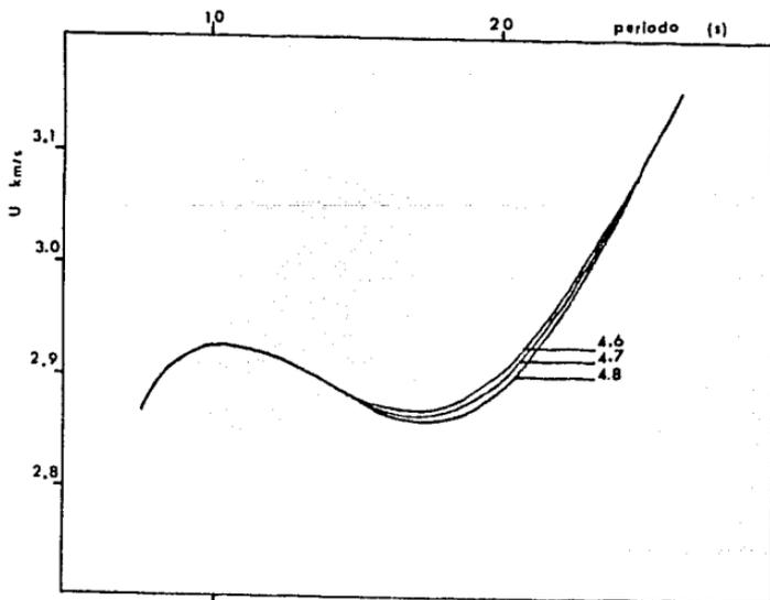
FIGURA A.9 Efectos de la variación de la velocidad  $S$  en la capa 5, desde 4.6 km/s hasta 4.8 km/s.
