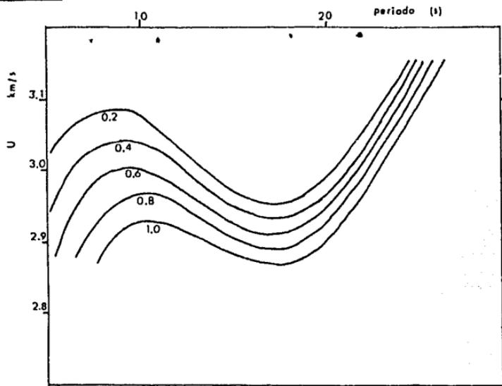
FIGURA A.2 Efectos de la variación del espesor de la capa 1, desde 0.2 km hasta 1.0 km.
