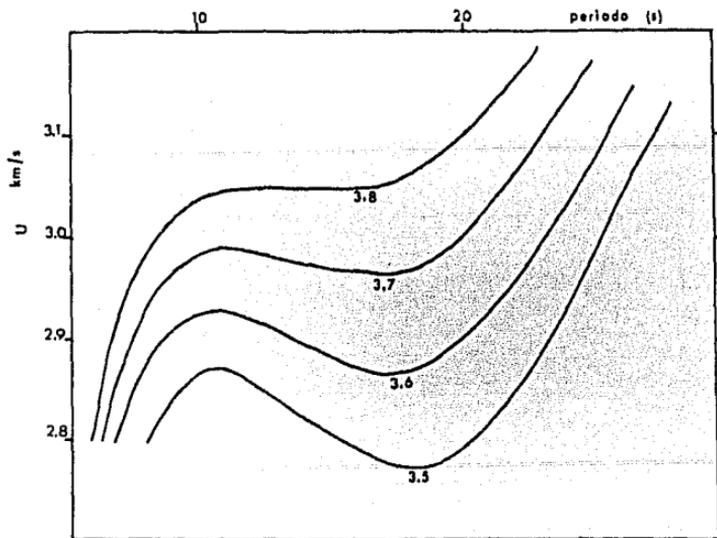
FIGURA A.5 Efectos de la variación de la velocidad  $S$  en la capa 3, desde 3.5 km/s hasta 3.8 km/s.
