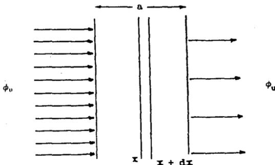
Fig. 4-1. Ilustración de la atenuación de partículas en un medio absorbedor.
