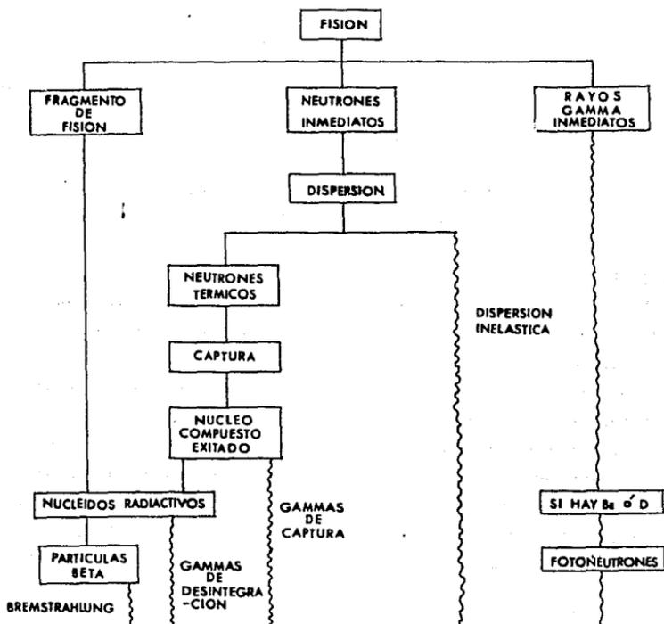
Fig. 1-1. Radiaciones procedentes de un reactor nuclear.
