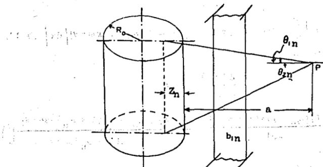
Fig. 5-9. Esquema para el cálculo del flujo total procedente de la parte lateral de una fuente cilíndrica.
