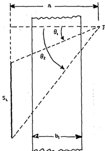
Fig. 4-5. Cálculo del flujo virgen procedente de una fuente lineal isotrópica detrás de un blinaje en forma de placa (caso III).
