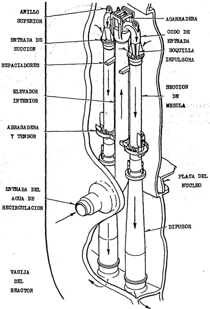
Fig. 7-6. Vista isometrica de una bomba de chorro.
