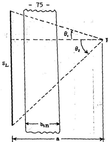
Fig. 5-5. Esquema del cálculo del flujo total procedente de una fuente lineal isotrópica detrás de un blindaje en forma de placa (caso II).
