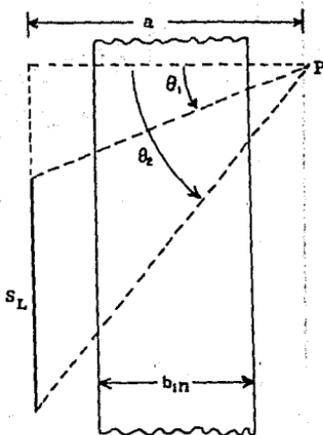
Fig. 5-6. Esquema del cálculo del flujo total procedente de una fuente lineal isotrópica detrás de un blindaje en forma de placa (caso III).
