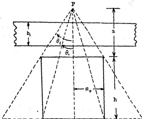
Fig. 4-8. Cálculo del flujo virgen en el punto P sobre la tapa de una fuente cilíndrica.
