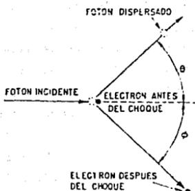
Fig. 2-3. Representación esquemática de la dispersión Compton.
