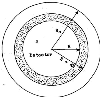
Fig. 4-2. Cálculo del flujo virgen en el centro de una fuente esférica.
