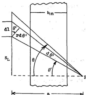
Fig. 5-4. Esquema del cálculo del flujo total procedente de una fuente lineal isotrópica detrás de un blindaje en forma de placa (caso I)
