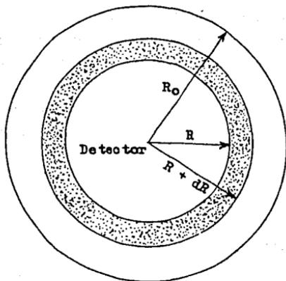
Fig. 5-4. Diagrama base para el cálculo del flujo total en el centro de una fuente esférica.
