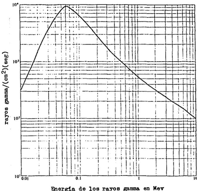
Fig. 7-8. Intensidad del flujo de rayos gamma requerido para dar una razón de exposición de un mR/hr como una función de la energía de los rayos gamma.
