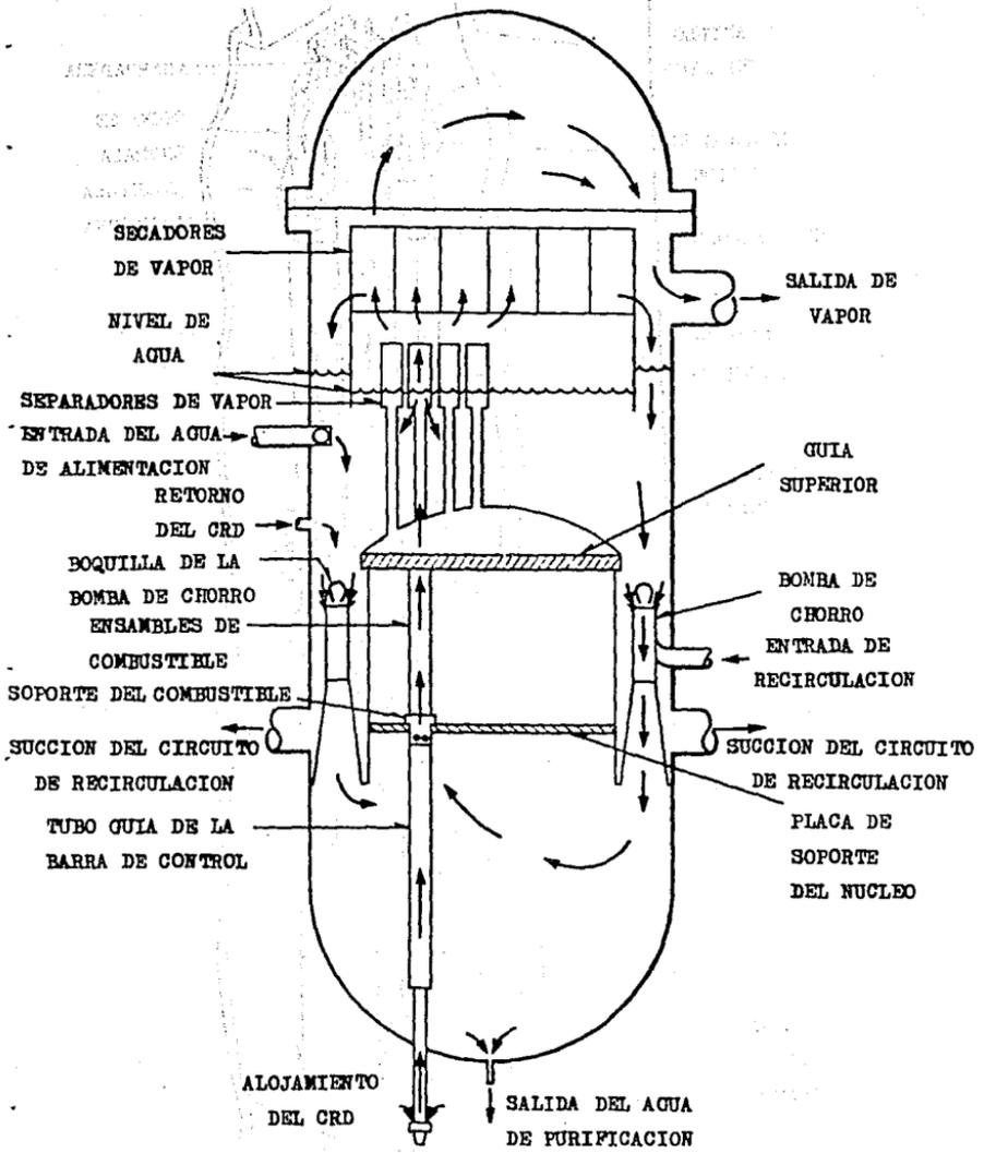
Fig. 7-5. Flujos de agua a través de la vasija del reactor.
