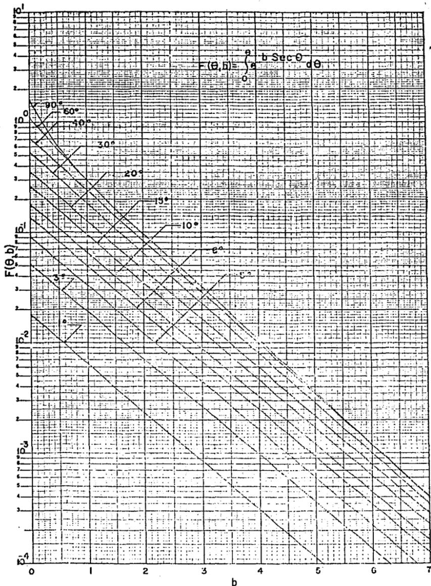
Fig. AI-1. Grafica de la función integral de Sievert.
