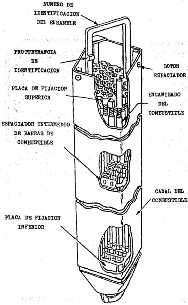
Fig. 7-2. Ensamble de combustible.
