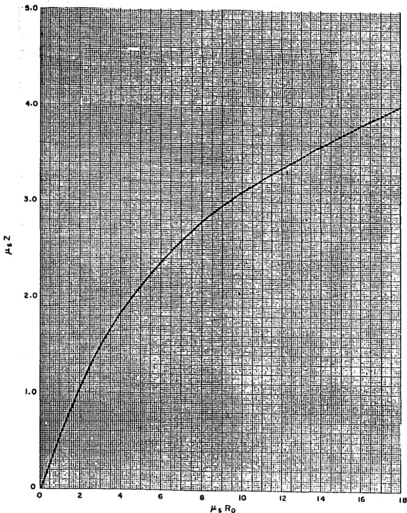
Fig. 4-10. Distancia de autoabsorción,  $Z$ , de un cilindro como una función del radio del cilindro,  $R_0$ , para  $a/R_0 \approx 1.0$
