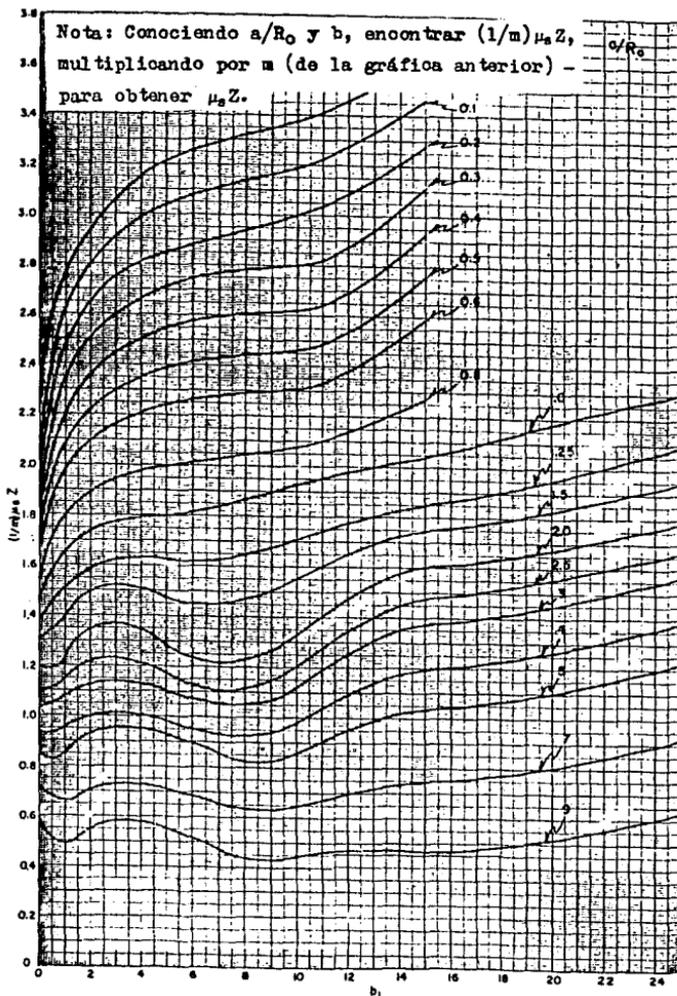
Fig. 4-12. Distancia de autoabsorción,  $Z$ , de un cilindro como una función del radio del cilindro,  $R_0$ , para  $a/R_0 < 10$ .
