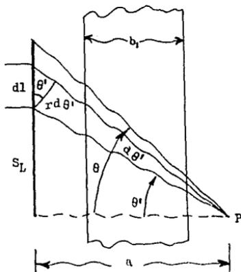
Fig. 4-3. Cálculo del flujo virren procedente de una fuente lineal isotrópica detrás de un blindaje en forma de placa (caso I).
