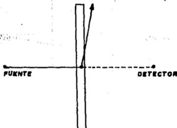
Fig. 5-1. Dispersión de la radiación en un blindaje delgado.
