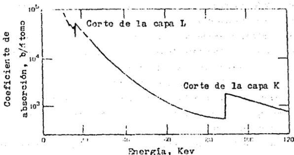
Fig. 2-2. Efecto fotoeléctrico para el plomo.
