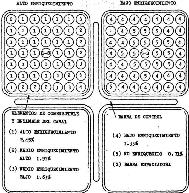
Fig. 7-3. Disposición de los elementos combustibles en los canales y situación de la barra de control.
