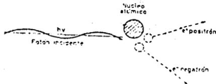
Fig. 2-4. Representación esquemática de la producción de pares.
