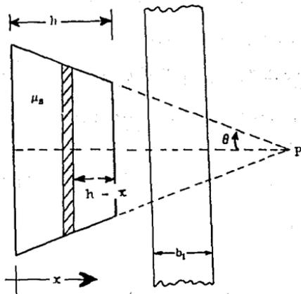
Fig. 4-7. Cálculo del flujo virgen procedente de una fuente homogénea e isotrópica en forma de cono truncado detrás de un blindaje en forma de placa.
