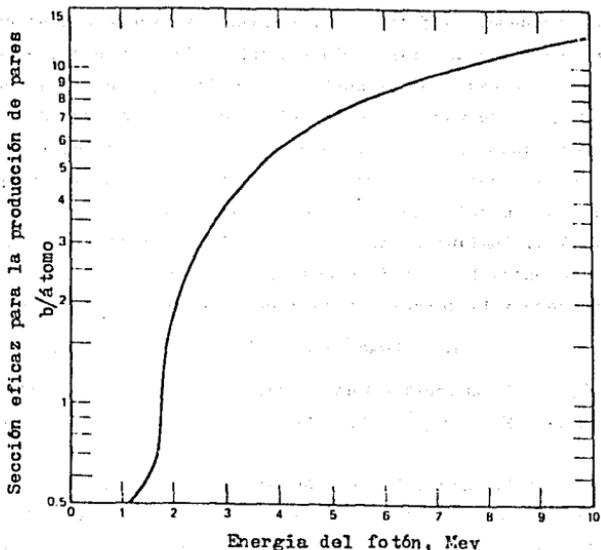
Fig. 2-5. Sección eficaz para la producción de pares en plomo.
