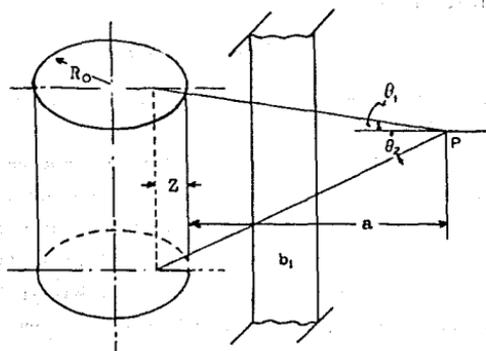
Fig. 4-9. Cálculo del flujo virgen procedente de la parte lateral de una fuente cilíndrica.
