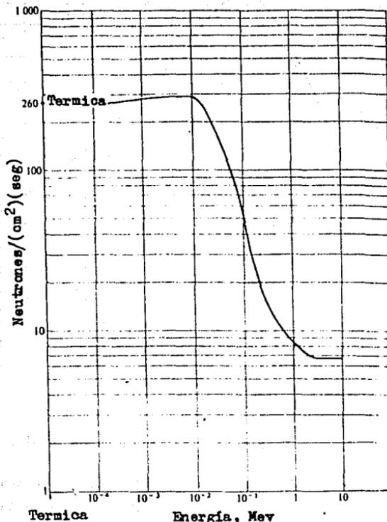
Fig. 7-9. Flujo de neutrones que da una razón de dosis de un  $\text{mrem/hr}$  como una función de la energía de los neutrones.
