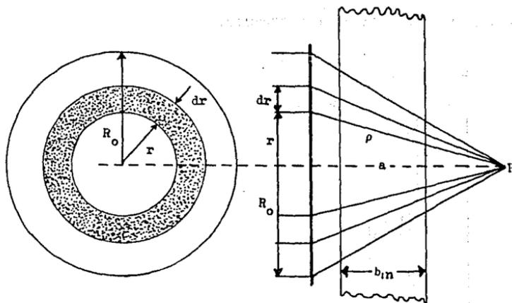
Fig. 5-7. Esquema para el cálculo del flujo total procedente de una fuente plana circular detrás de un blindaje en forma de placa.
