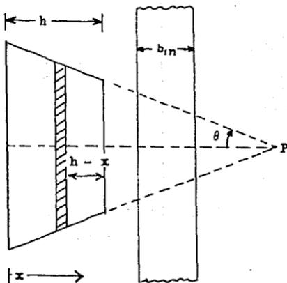
Fig. 5-8. Esquema para el cálculo del flujo total procedente de una fuente en forma de cono truncado detrás de un blindaje en forma de placa.
