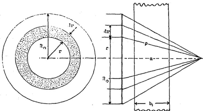
Fig. 4-6. Cálculo del flujo virgen procedente de una fuente plana circular detrás de un blindaje en forma de placa.
