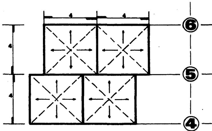
Losa bovedilla y vigueta (pref.) - (tablas) -  $350\text{kg}/\text{m}^2$  para un claro de 4.50 m.
