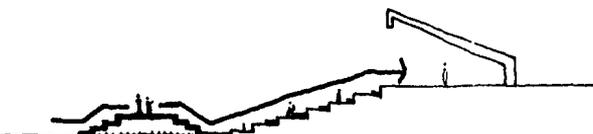
EL ACCESO AL EDIFICIO SE REALIZARA A TRAVES DE UN PUEBTE Y LUEGO A TRAVES DE UNA - ESCALINATA.
